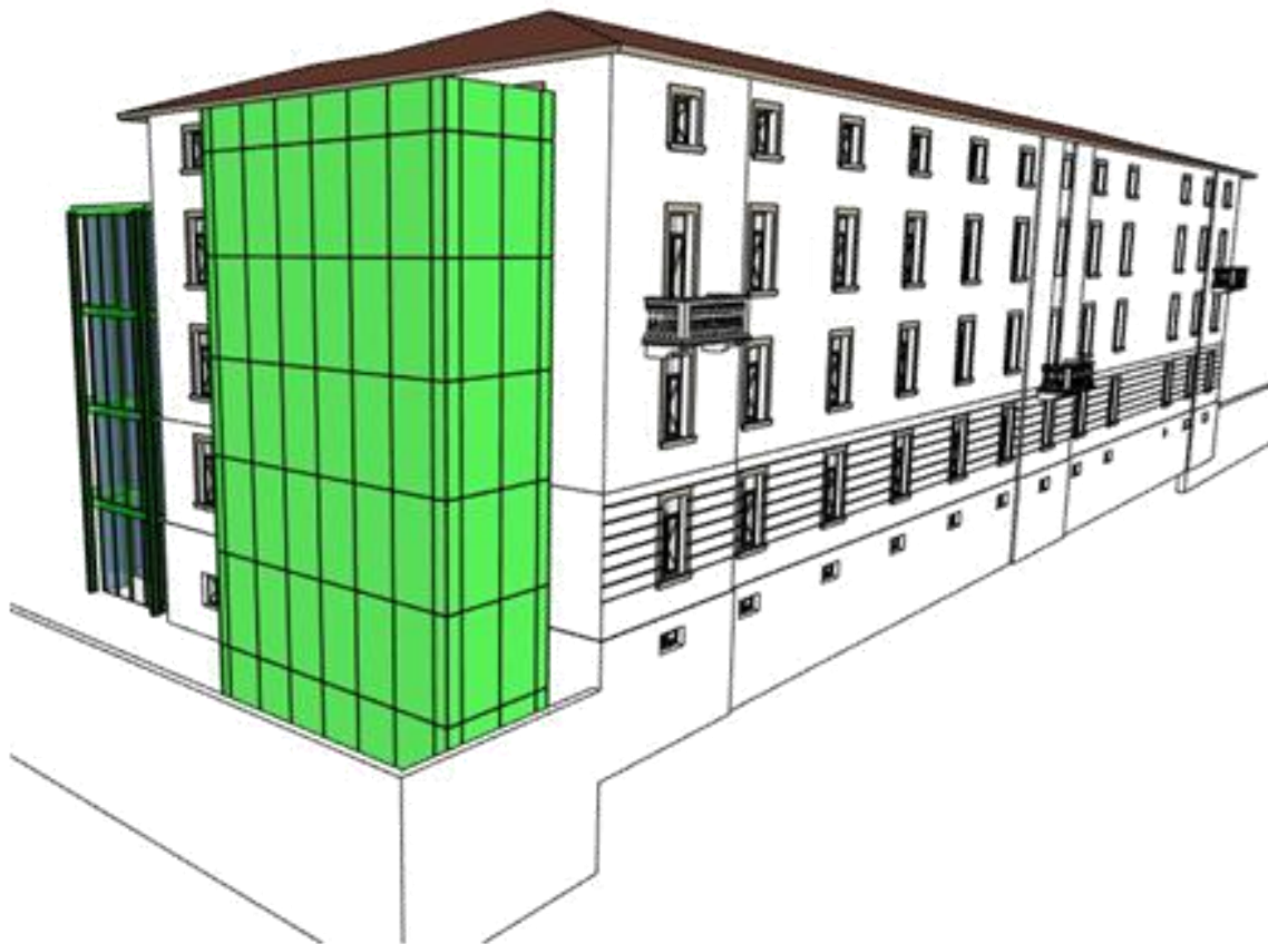
Rivestimento facciata ventilata in gres
