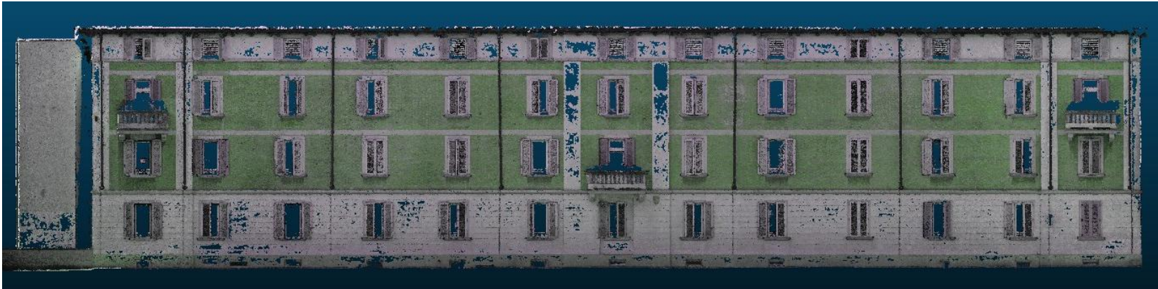
Nuvola di punti da scansione fotogrammetrica
