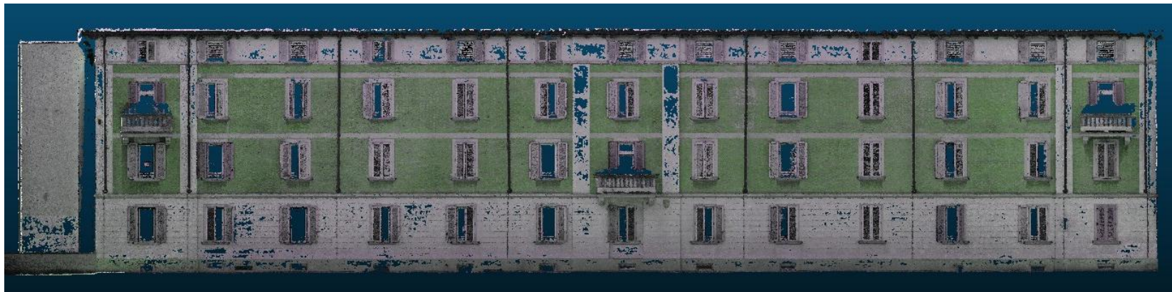
Nuvola di punti da scansione fotogrammetrica
