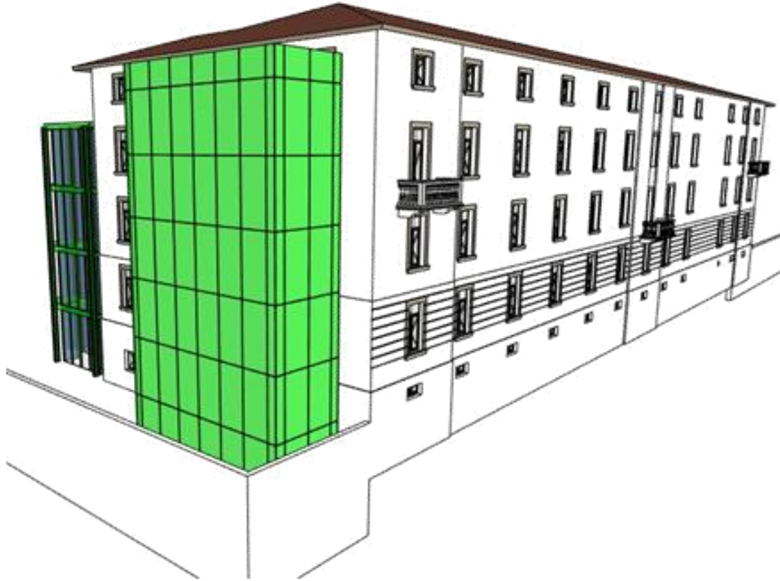
Rivestimento facciata ventilata in gres
