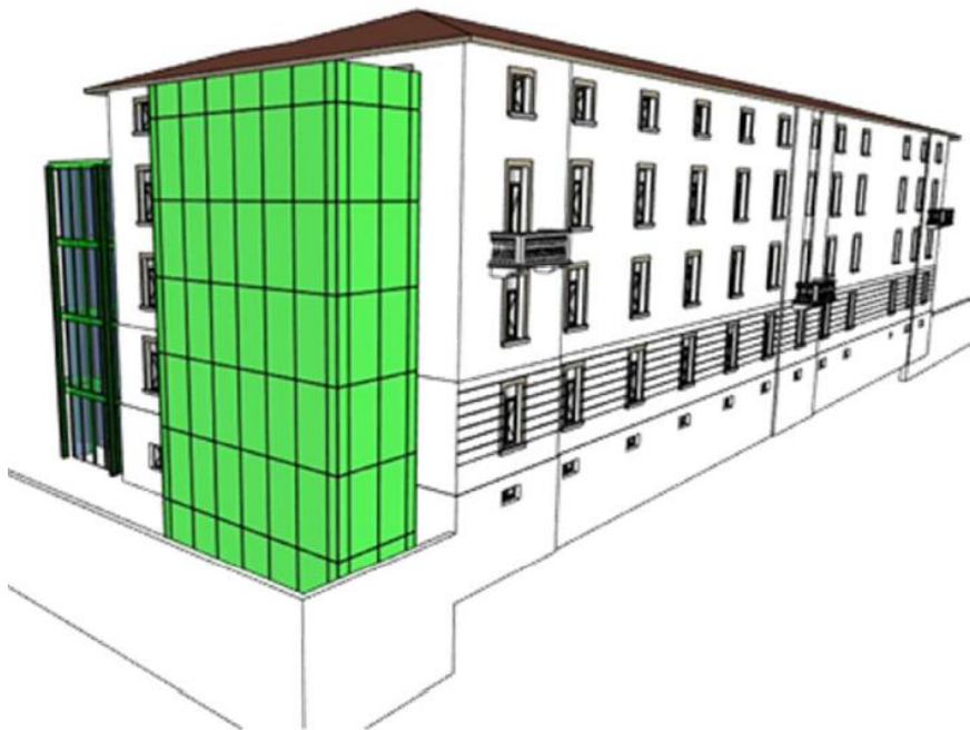
Rivestimento facciata ventilata in gres
