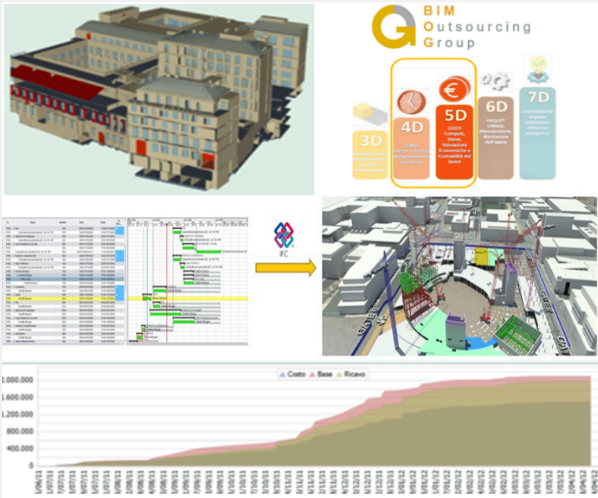
Fig. 8 - Un esempio di utilizzo della metodologia BIM nelle dimensioni 4D e 5D
