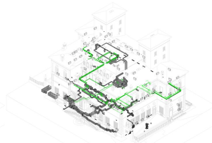
Modello impianto di climatizzazione
