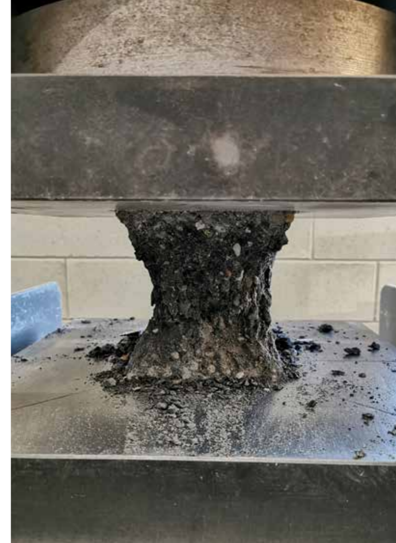
Rottura provino con biochar Break test biochar specimen
