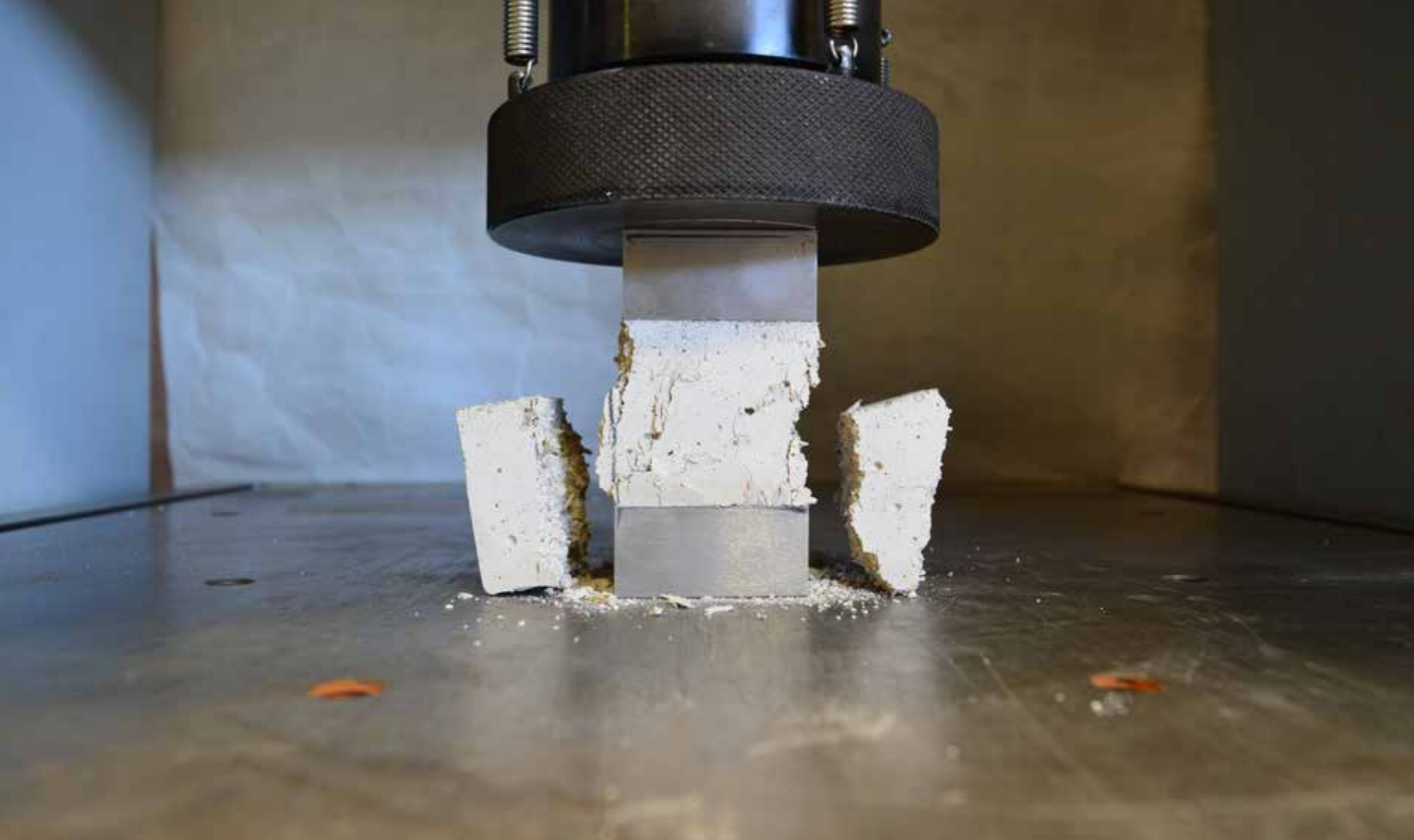
Determinazione della resistenza a compressione di una malta sperimentale
