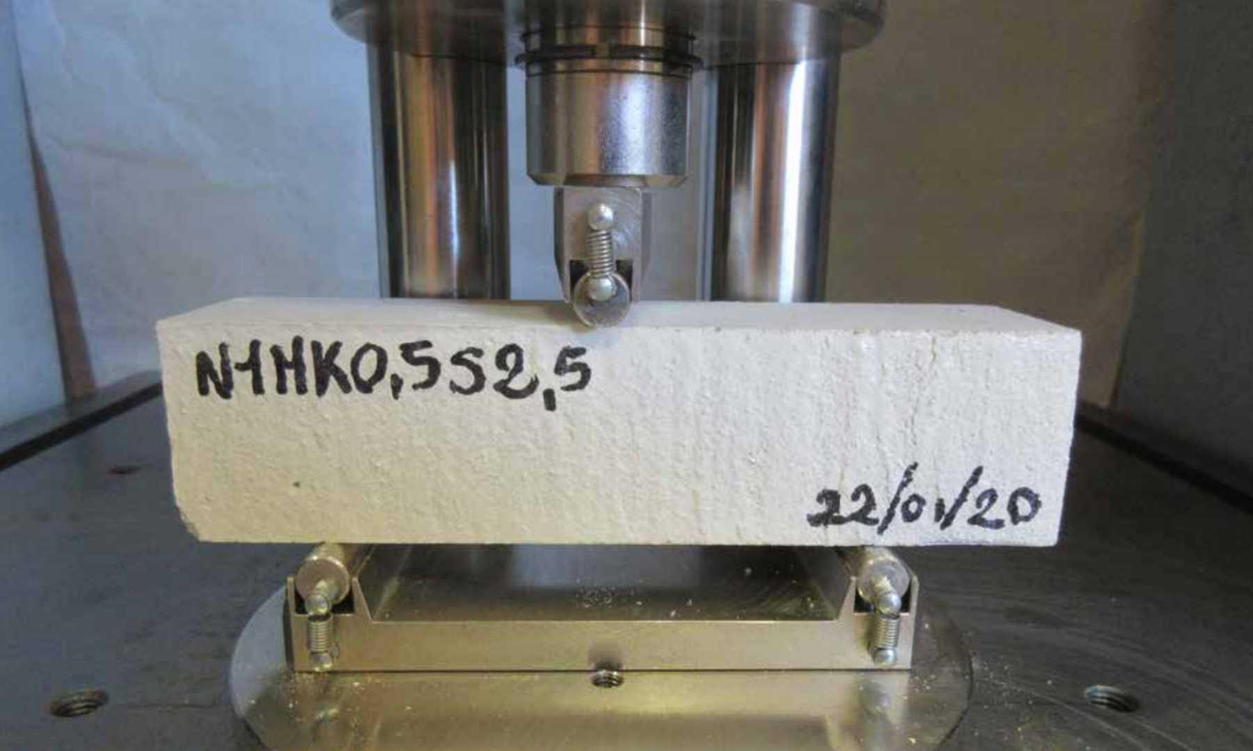
Determinazione della resistenza a flessione di una malta sperimentale
